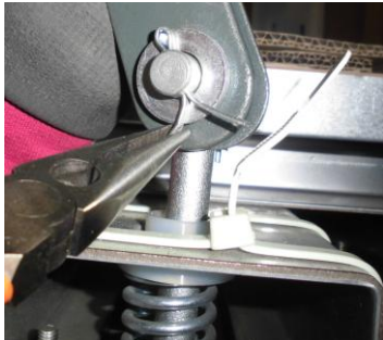
钢丝绳绳头固定 (rope hitch) 的安装
